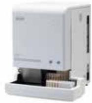
尿沈渣領域で初の自社開発となる自動分析装置「オーションアイ AI-4510」は、尿中の有形成分を撮影し、独自のアルゴリズムで画像を自動分類、腎疾患や尿路疾患の診断材料となるデータ提供が可能です。1時間に60検体の分析が可能で、尿中の赤血球や白血球、扁平上皮細胞など12項目を自動で測定できるのが特徴です。臨床検査技師による手動での分析業務の効率化も図れます。
